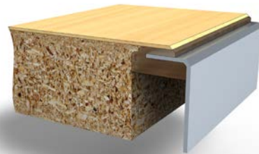
Flächenbündige Spüle von unten eingebaut
